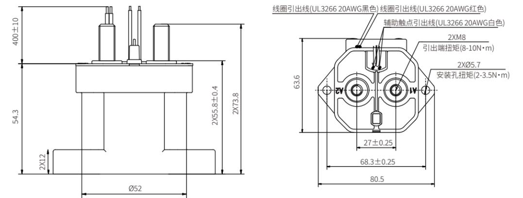
备注: 1.紧固件规格:2xM8x8mm; 2.接触器底座螺丝为M5 扭力要求2-3.5N·m;
